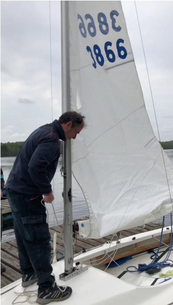
Großfall fieren, mit der Hand ins Vorliek greifen und Hoken. Den Kopf vom Fall abschäkeln. Tuch lagenweise auf dem Baum zusammenfalten und darauf achten, dass die Segellatten parallel zum Baum liegen. Das Tuch auf dem Baum festbinden.
